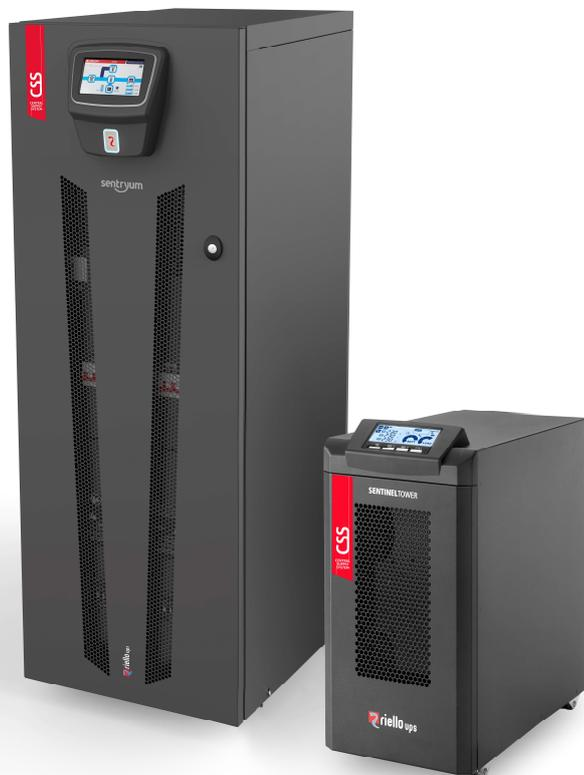
Le soluzioni CPS Riello UPS mantengono tutte le caratteristiche e le prestazioni proprie dei sistemi UPS, garantendo inoltre tempi di ricarica ridotti, capacità di sovraccarico continuo fino al 120%, equipaggiamento con batterie ad alte prestazioni e vita attesa di almeno 10 anni, struttura meccanica conforme alla normativa EN 60598-1, protezione contro l'inversione delle batterie (errato collegamento) e possibilità di operare secondo tutte le modalità previste dalla norma.
